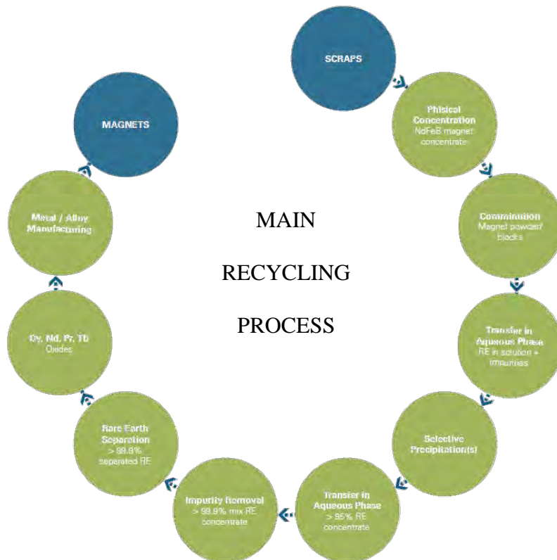
Abbildung 1: Mögliche hydrometallurgische Prozessroute zur Rückgewinnung Seltener Erden aus Magnet-Schrottgemischen mit der physikalischen Aufkonzentration von Dauermagneten zu Beginn der Wertschöpfungskette [1]
