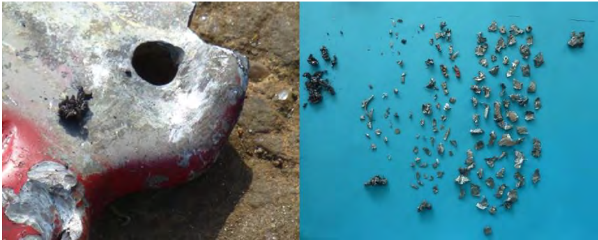
Abbildung 133: Links: Magnete in der Schredderschwerfraktion , Rechts: Festplattenschrott aufgeschlüsselt nach Korngrößen von links nach rechts aufsteigend mit getrennter Nd Fraktion (unten) [14]
