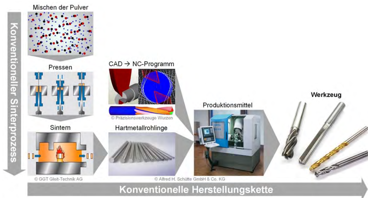
Abbildung 1: Klassische Herstellung von Hartmetall-Zerspanwerkzeugen
