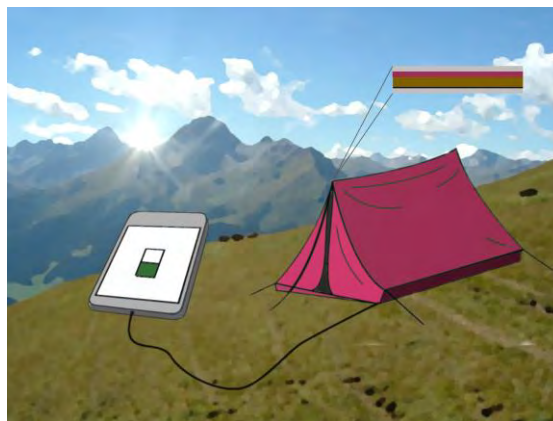
Abb. 1: Zelt mit Farbstoffsolarzellen zum Aufladen des Handys.
